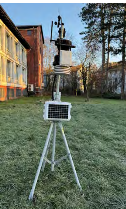
Datenfutter für die KI: Auf dem Gelände der Stadt Schwerte sammelt eine Wetterstation des Projekts AirGuardAI Daten zu Feinstaub, Temperatur und Wind – Basis für die KI zur Vorhersage der Luftqualität.
